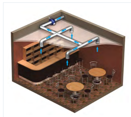
Wariant zastosowania wentylatora VKM w kawiarni.
